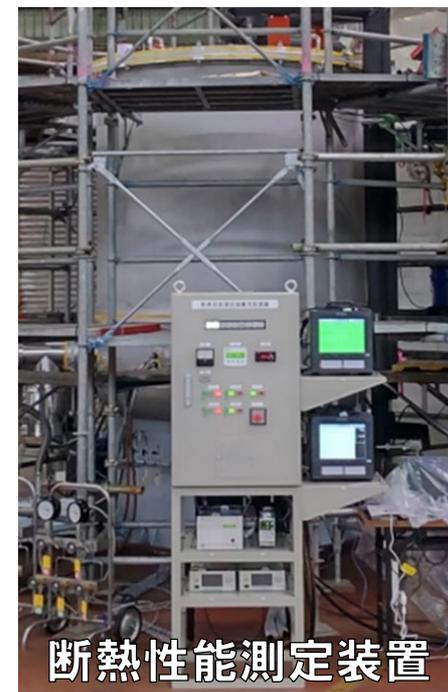
断熱性能測定装置
