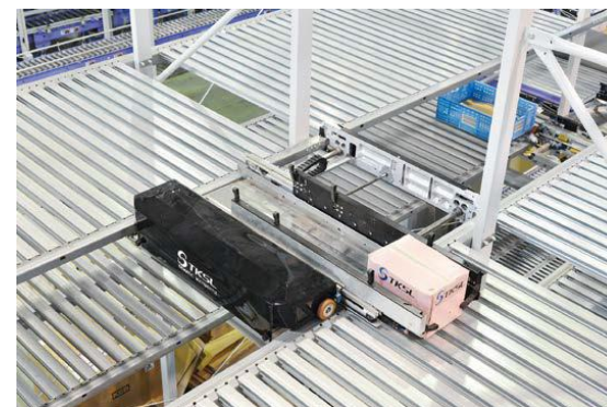
シャトルが棚の間を動き回り 各段の棚に荷物を出し入れを行う
