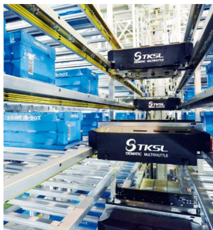
シャトルが棚の間を動き回り 各段の棚に荷物を出し入れを行う
