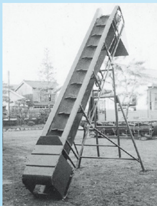
初期の土木建築工事用コンベヤ
