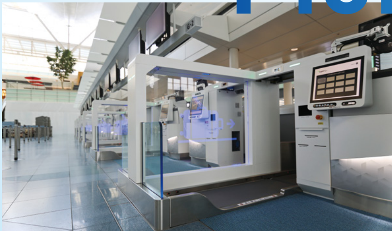
羽田空港に納入した顔認証システム搭載型の自動手荷物預入機
